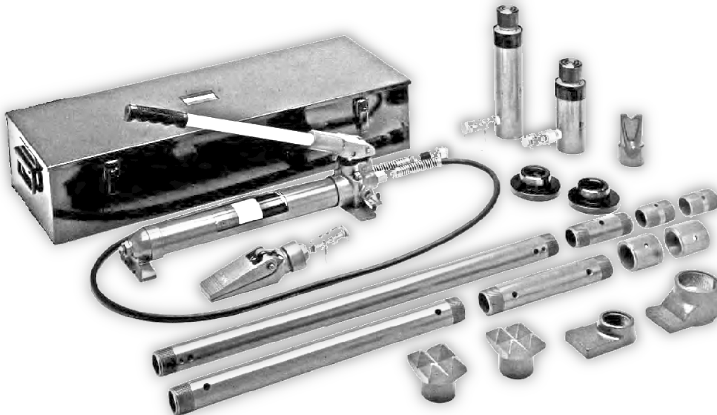
Гидравлический ручной насос («Holmatro», «Enerpak»)
